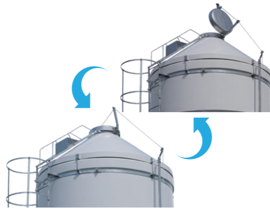
遠隔開閉器の開閉状況
